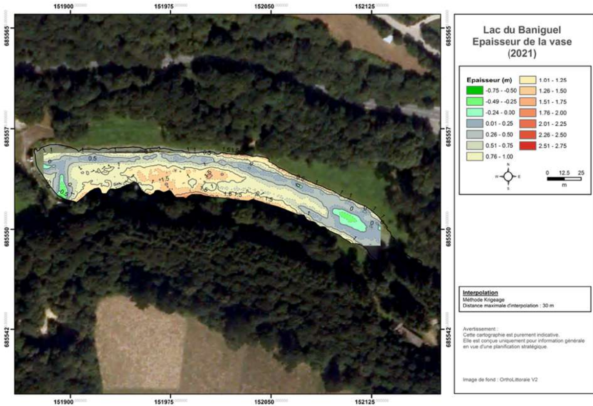
Figure 54 : Différentiel bathymétrique 2021 – 1996 pour Baniguel (source Vivadour)
