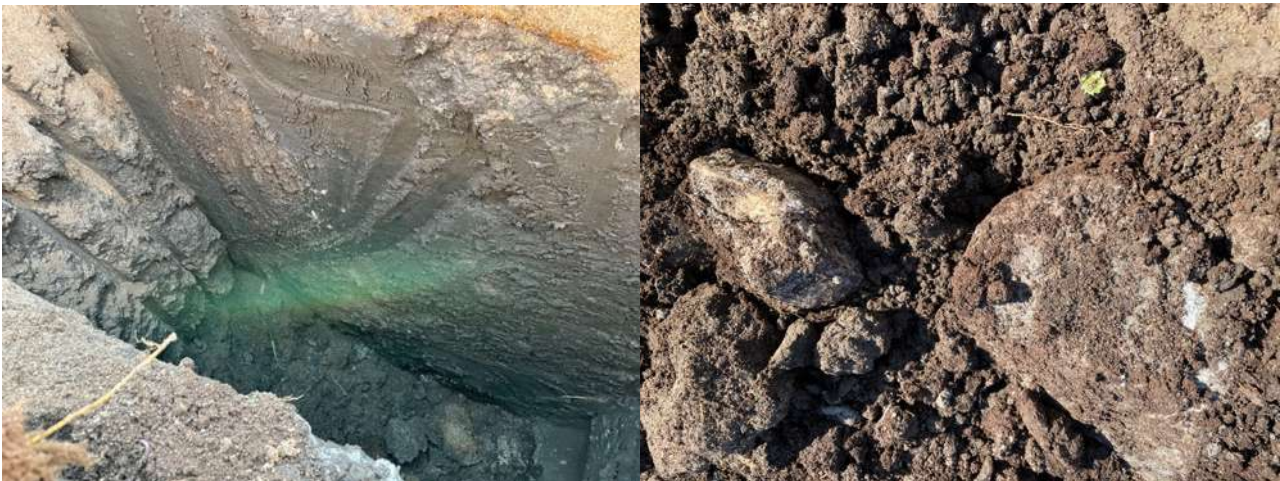
Figure 60 : Point de sondage 93 - Le sédiment en place s'est ressuyé avec le temps et correspond à un sol un peu limoneux. Il a été trouvé au fond des galets (source Gaïa)
