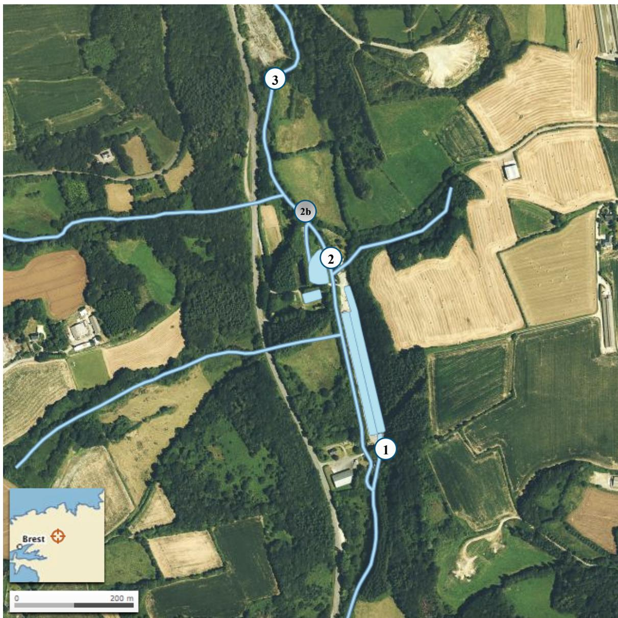
**Illustration 15** Position des points de prélèvement : 1 (entrée), 2 (sortie 1 après filtre), 3 (sortie2+150m).
